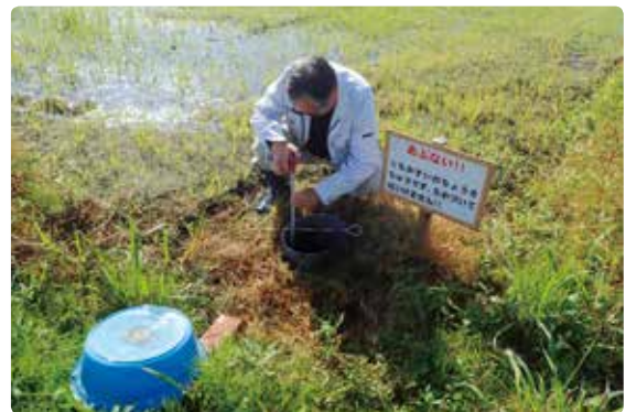
地下水位計測状況
