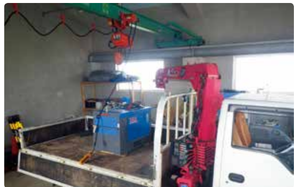
写真-3 移動式発電機積載状況
