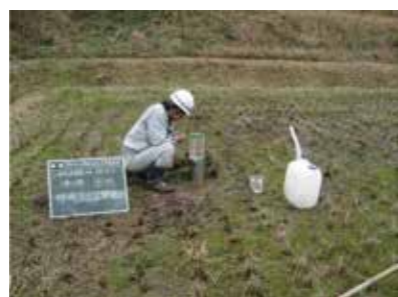
現場透水試験
