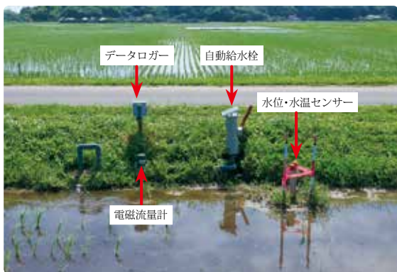
装置設置状況
