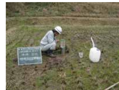
現場透水試験
