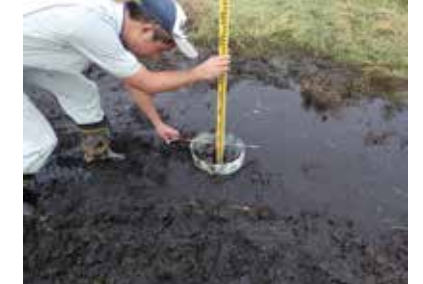
試験孔の設置
