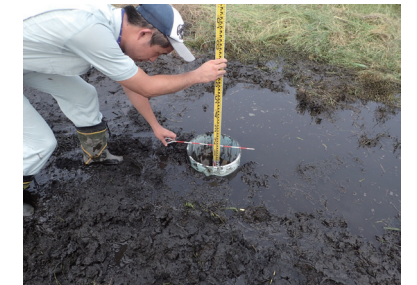
試験孔の設置
